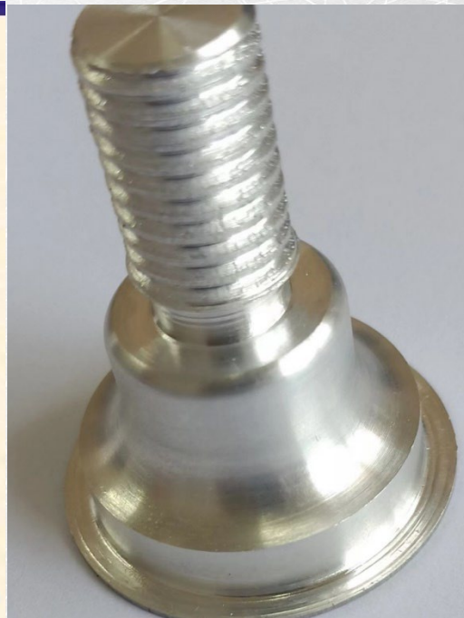
图9-5 外径、内径粗车循环指令G71
